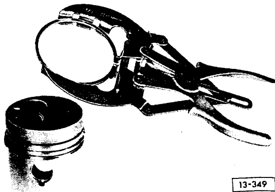
Fig. 6 Segments de piston: dépose et repose L'inscription "TOP" doit être dirigée vers le fond du piston.
